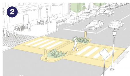
Повдигната пешеходна пътека с междинен остров за изчакване
